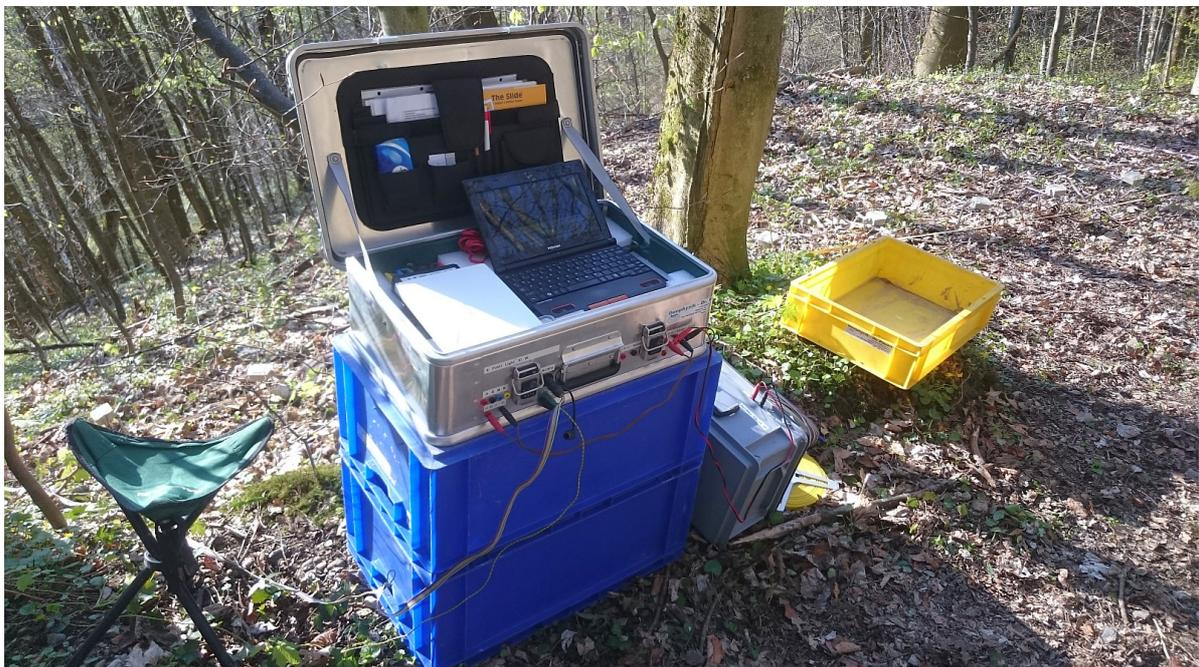
**Foto 2:** Die ActEle Boxen sind mit einem Flachbandkabel untereinander und mit dem Messgerät in der Alu-Box verbunden. Die Alu-Box enthält auch den Netbook Rechner mit dem Messprogramm Geotest. Die graue Kunststoffbox beinhaltet einen 12 V Akku als Energiequelle für die geoelektrischen Messungen. Hier: Profil 2017-3.
