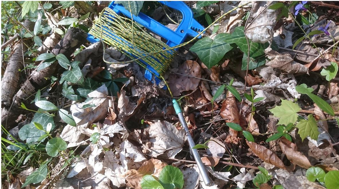
**Foto 3:** Die Erdungs-Elektrode (GND Elektrode) misst das elektrische Bezugspotential für alle anderen Elektroden. Hier: Profil 2017-3.
