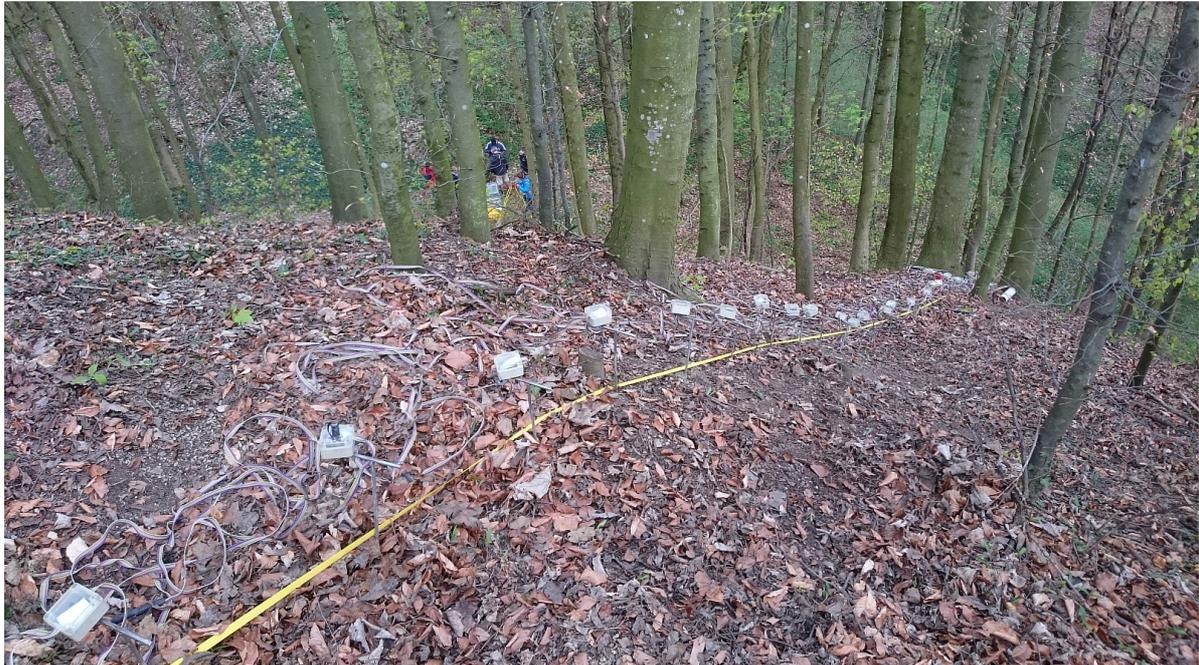
**Foto 1:** Das Profil 2017-1 verläuft vom südlichen Burghügel bergab in Richtung auf den Sattel zwischen den beiden Burgbergen. Entlang des gelben Maßbandes sind im Abstand von je 0.5 m Edelstahl-Elektroden platziert. Die kleinen Boxen auf jeder Elektrode enthalten die Elektronik zur Ansteuerung (ActEle).
